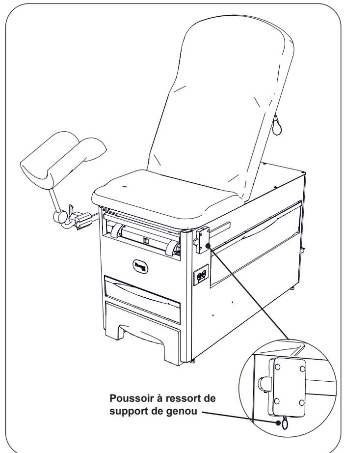
Figure 13. Élément de fixation de support de genou
