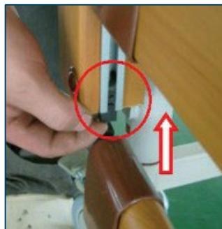
Terminez en insérant l'autre glisseur dans l'alliage d'aluminium et en soulevant les rails latéraux à la position la plus élevée.
