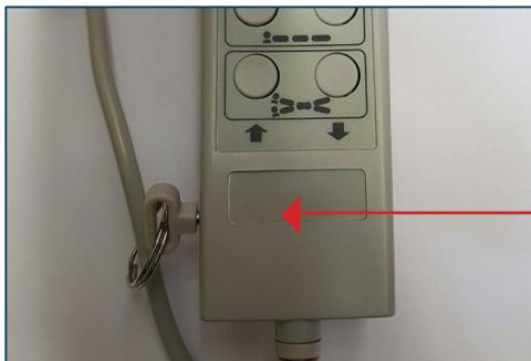
Assurez-vous que la clé de sécurité est branchée sur le côté du contrôleur manuel.
